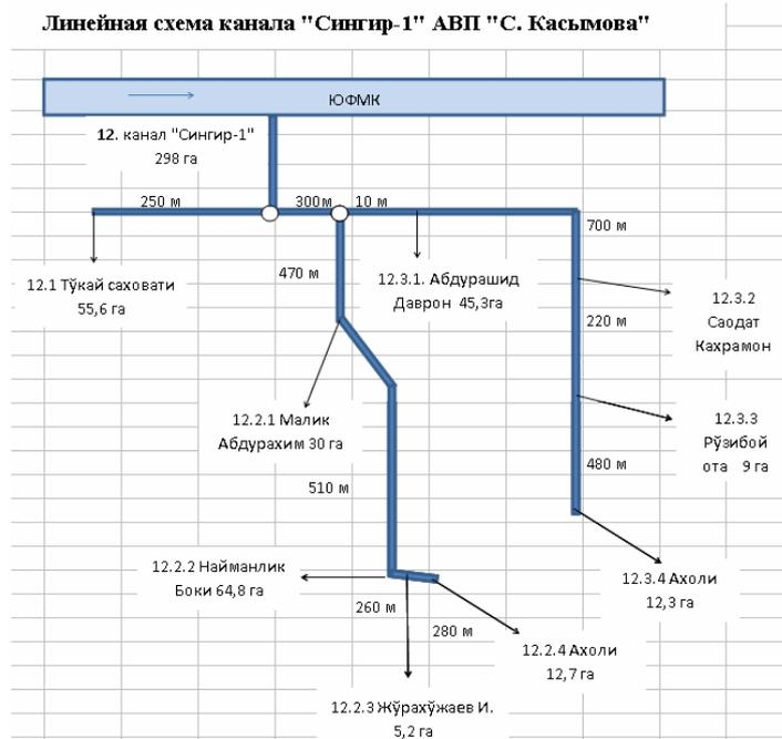
Рис. Линейная схема канала «Сингир-1»
